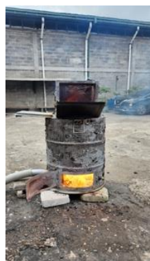
Gambar 4. Kondisi proses pembakaran dengan insinerator
